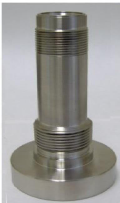
A área de passagem do bocal tem que ser grande o suficiente apenas para permitir que uma determinada quantidade de fluxo, isto é, a capacidade de vazão requerida pelo processo, seja aliviada para ocorrer a redução de pressão. Porém, essa capacidade de alívio requerida nunca deve ser menor que 30% da capacidade de vazão efetiva da válvula de segurança, quando operando principalmente com fluidos compressíveis.
