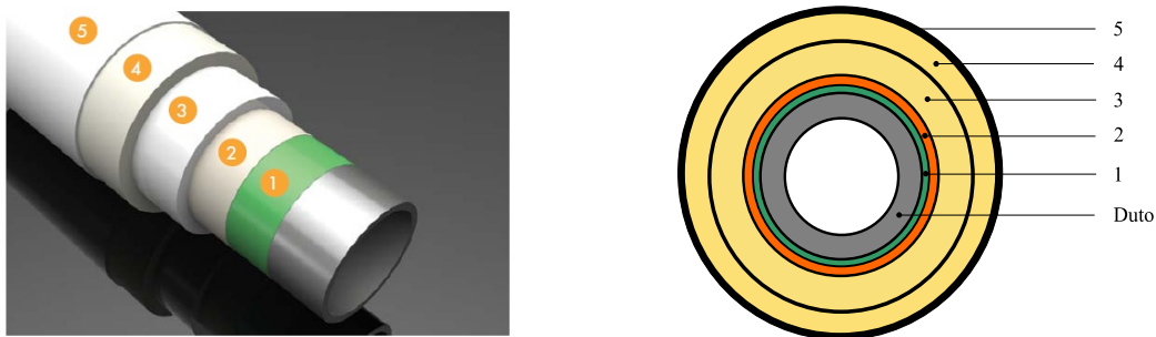
Figura 9.14 Duto com cinco camadas. 1- Epóxi fundido a alta temperatura na parede (0,25 mm); 2- Adesivo (0,3 mm); 3- Polipropileno sólido (20 mm); 4- Espuma de polipropileno (15 mm); 5- Proteção externa de polipropileno (3 mm).
