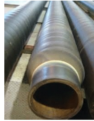
Figura 9.11 Duto de aço com isolamento térmico, sem proteção externa.
