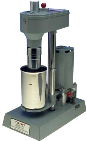
Figura 3.7 - Reômetro para análise de viscosidades (Fann, 2012)
