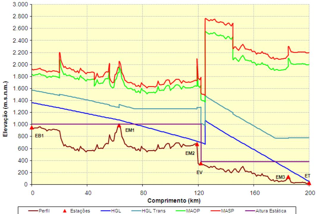
Figura 4.13 - Batch de polpa impulsionando água a 67%, quilômetro 125, ano 0
