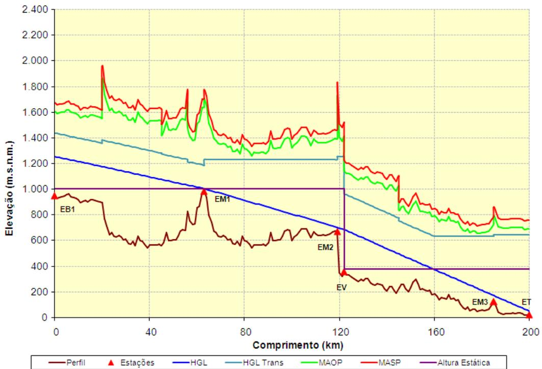
Figura 4.11 - Gradiente Hidráulico do sistema a 65% e vazão de 1.977 m<sup>3</sup>/h, Ano 20
