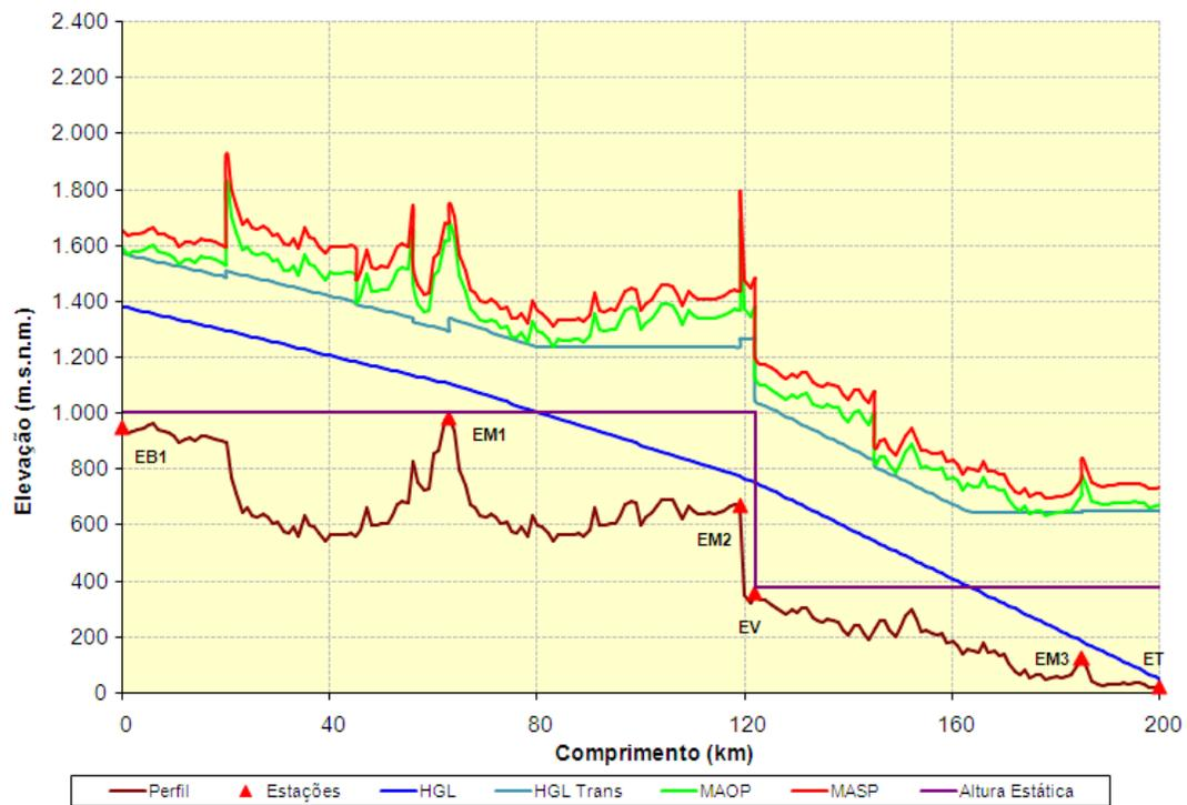
Figura 4.7- Gradiente Hidráulico do sistema a 67% e vazão de 2.067 m<sup>3</sup>/h, Ano 20
