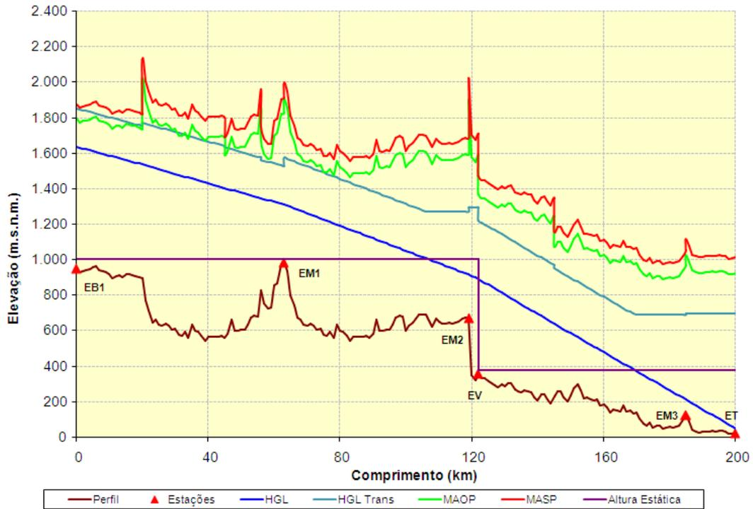
Figura 4.8 - Gradiente Hidráulico do sistema a 70% e vazão de  $2.163 \text{ m}^3/\text{h}$ , Ano 0
