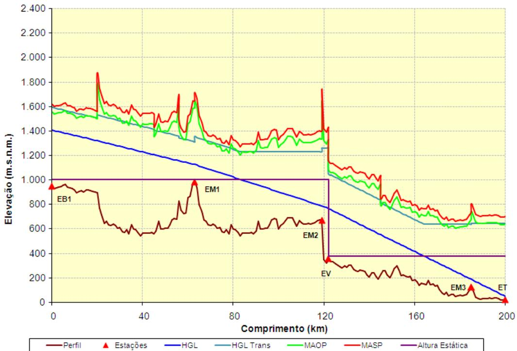
Figura 4.9 - Gradiente Hidráulico do sistema a 70% e vazão de  $2.052 \text{ m}^3/\text{h}$ , Ano 20
