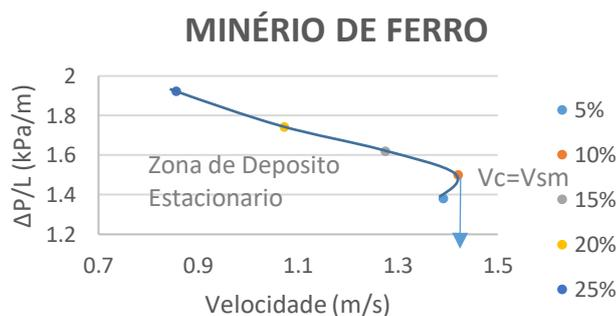
**Figura 8.** Variação da velocidade crítica de deposição com variação de  $C_v$  (classe 2).
