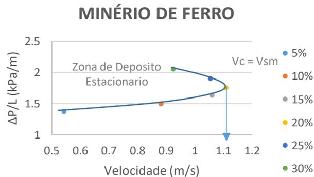
**Figura 7.** Variação da velocidade crítica de deposição com variação de  $C_v$  (classe 1).
